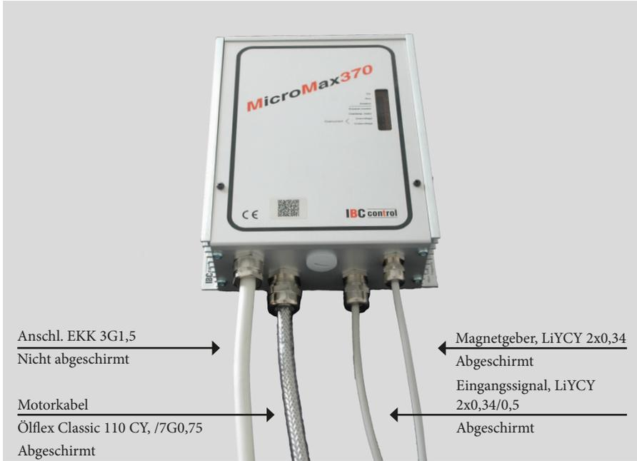
EMV-Verschraubung ist für abgeschirmtes Kabel zu verwenden.
