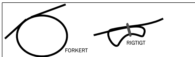
Fig. 4 Hvis en del af motorkablet bliver tilovers, samles det sammen, så den overflade, som indesluttet, bliver så lille som muligt.
