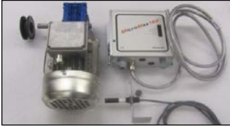
Neri Motor mit MicroMax und Rotorlaufkontrolle
