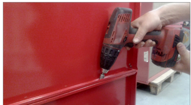
Bild 6: Flansche der Seitenwände aufeinanderschrauben
