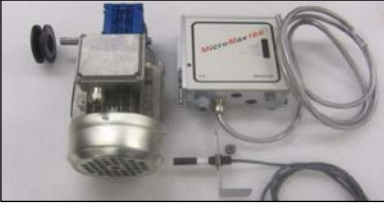
Neri Motor mit MicroMax und Rotorlaufkontrolle
